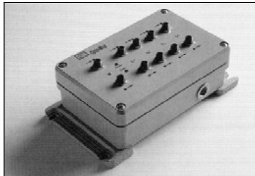
Mit dem Modul können 4 bidirektionale optische Kanäle zu einem optischen Summenkanal gemultiplext und übertragen werden. Die Datenübertragung wird durch eine gelbe LED angezeigt. Auf Anfrage können auch Module mit 4 elektrischen RS232 Ports geliefert werden. Die elektrischen Signale werden dann über den optischen Summenkanal übertragen. Auf Anfrage können auch andere optische Anschlüsse, Reichweiten und Wellenlängen geliefert werden.
