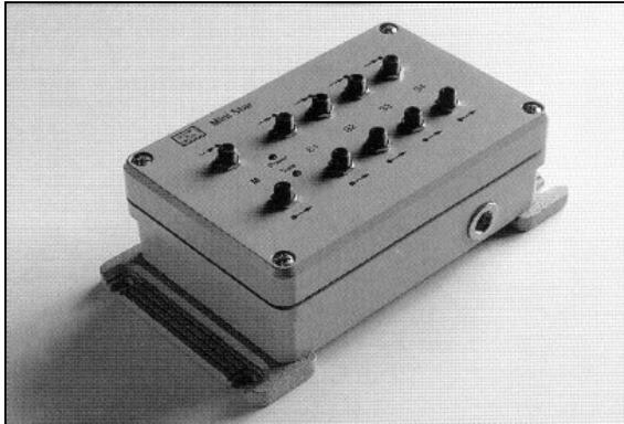
Modul im robusten Druckgußgehäuse zum Aufbau von Sternstrukturen. Die Daten werden vom Master auf die Slaves übertragen. Für die optische Verbindung stehen FSMA Anschlüsse zur Verfügung. Der Sternkoppler arbeitet im Vollduplex-Modus. Die Übertragung der Daten wird durch eine gelbe LED. Auf Anfrage können auch andere optische Anschlüsse, Reichweiten und Wellenlängen geliefert werden.
