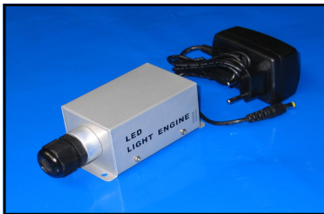
Type LED-006/3RGB 12VDC 3x2W RGB LED 31 Festprogramme Farbwahl o. autom. 14mm Gem. Ende L150xB75xH52mm
