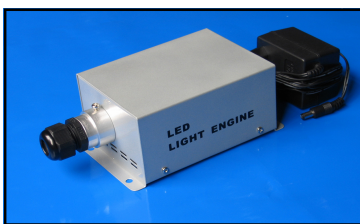
Type LED-005/MD 12VDC 5W Super bright LED 6-fach Farbwechsel Farbe fest o. autom. Geschw. einstellbar 14 mm Gem. Ende L175xB92xH65mm
